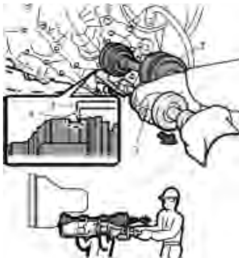
图 7-72 驱动轴的拆卸
