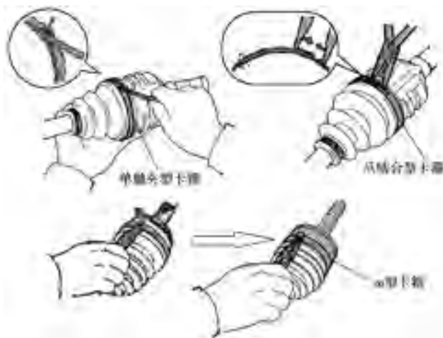
图 7-74 驱动轴橡胶护套卡箍的拆卸
