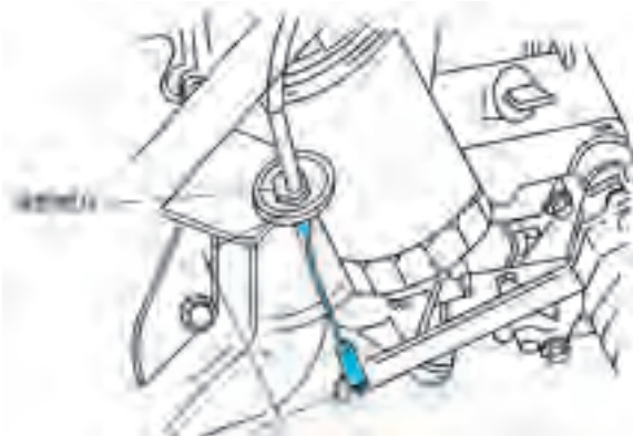
图 2-23 钢索式操纵机构离合器踏板自由行程的调整
