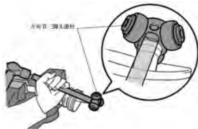
图 7-76 万向节三脚头球节滚柱的拆卸
