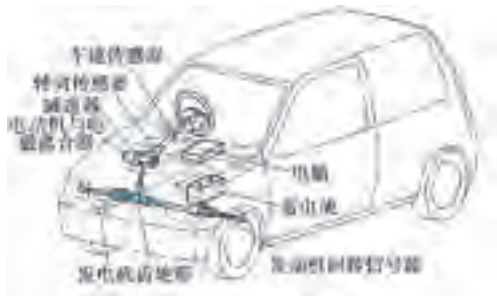
图 8-27 电动式动力转向系统装车实例
