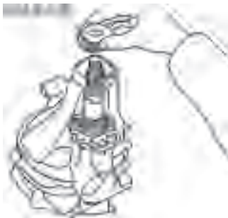
图 6-23 前轴承内圈的安装
