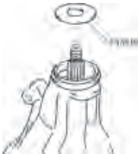
图 6-24 挡油板的安装
