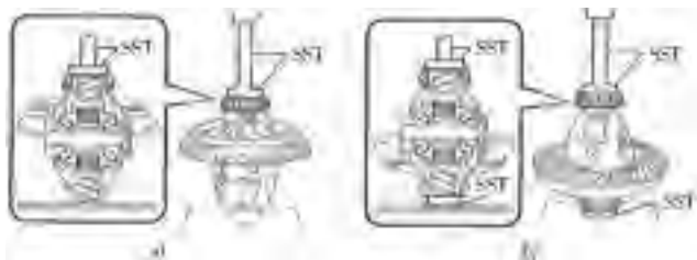
图 6-33 差速器轴承内圈的安装
