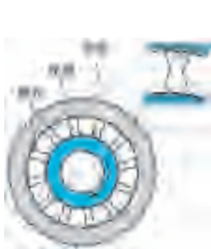
图 4-9 单向离合器的构造和锁止原理
