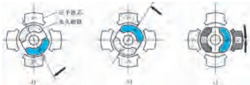
图 7-65 执行器工作原理
