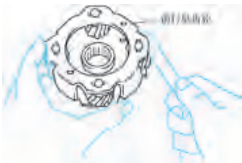
图 4-48 行星齿轮间隙的检查
