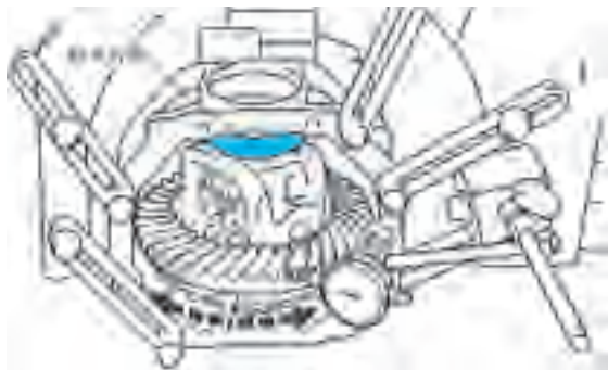
图 6-35 丰田皇冠主减速器主从、动锥齿轮齿隙检查
