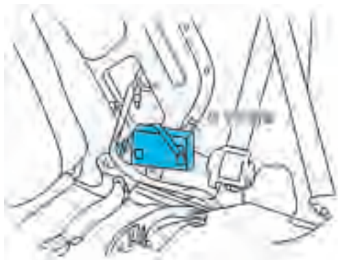
图 8-34 信号控制器安装位置
