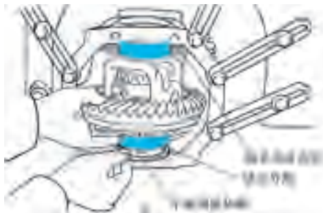
图 6-36 丰田皇冠主减速器主、从动锥齿轮齿隙调整
