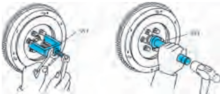
图 2-18 导向轴承的更换
