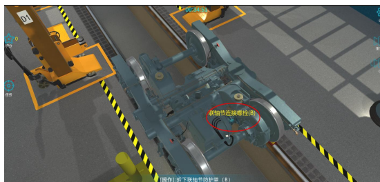
2.2.4 用吊具吊住电机（B）
